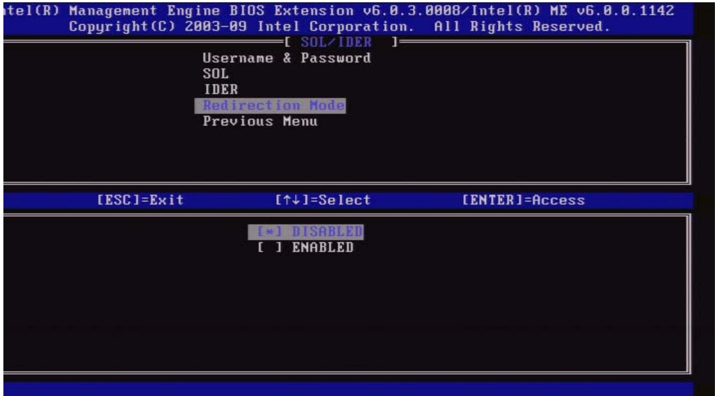
通过“Legacy Redirection Mode”（传统重定向模式），可控制重定向的工作方式。如果设置为禁用该模式，则在每次开始对话前，控制台都需要打开重定向端口。该情况针对支持打开重定向端口的企业控制台和新型 SMB 控制台而言。因为旧 SMB 控制台（Intel AMT 6.0 之前的版本）不支持打开重定向端口功能，所以需要通过此“Intel MEBx”选项手动打开重定向端口。
