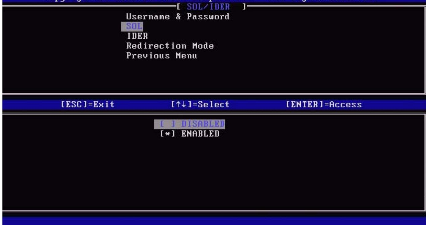
通过 SOL，可将 Intel AMT 管理的客户端控制台输入/输出重新定向到管理服务器控制台（如果客户端系统支持 SOL）。如果该系统不支持 SOL，则无法启用该值。
